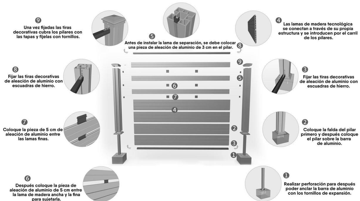
Disponemos de unos pilares de aluminio que están totalmente adaptados para ser anclados a la pared, siguiendo la misma facilidad para insertar las lamas de madera que en los pilares normales de WPC. Estos pilares de aluminio solo se utilizarán para anclarlos a la pared/columna ya que proporcionan una mayor estabilidad que si solo se utilizaran los pilares normales de WPC, puesto que éstos van anclados únicamente al suelo. \*(foto número 1).
